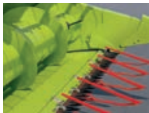
Zasunutí stolu žacího ústrojí – obilí (- 100 mm)
