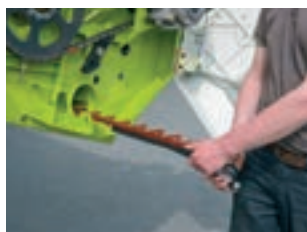
Náhradní kosa je vložena do spodní části žacího ústrojí
