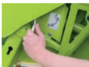
Zajištění děliče bez použití nářadí přes rychloupínání
