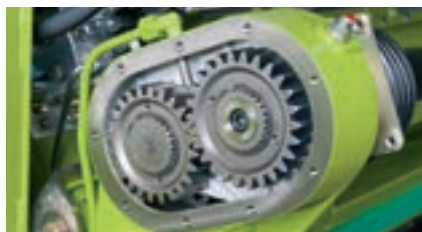
Výměna ozubeného kola pro přizpůsobení počtu otáček
