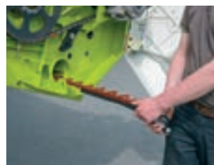
Náhradní kosa je vložena ve spodní části žacího ústrojí
