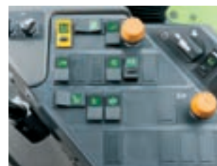
Aktivace automatiky přihaněče za pomoci kolébkového spínače v boční konzole.
