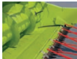
Vysunutí stolu žacího ústrojí – obilí (+ 100 mm)
