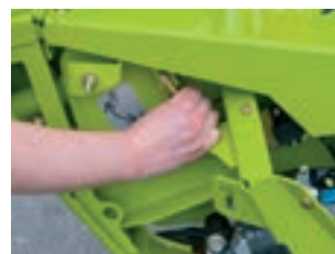
Zajištění děličů a dělicí kosa pro sklizeň řepky bez použití náradí pomocí rychloupínání
