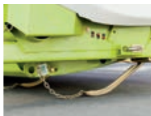
Třmenové hmatače zaznamenávají pozici žacího ústrojí.
