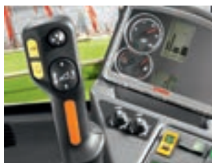
AUTO CONTOUR aktivujete jednoduše tlačítkem pro regulaci výšky, umístěným na multifunkční páce.
