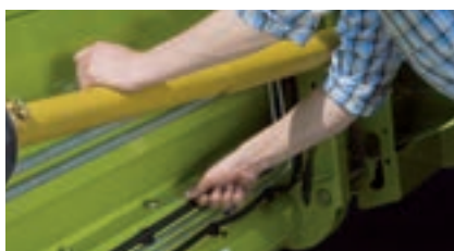
Stírací plechy jsou nastavitelné zvenčí (C 490, C 430, C 370)
