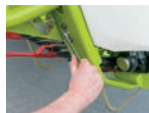
Snadné přestavení výšky děliče pomocí klapkového klíče
