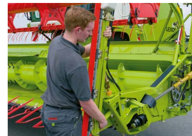
Připojení řepkového děliče přes rychloupínání
