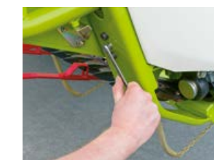
Snadné přestavení výšky děliče pomocí klápkového klíče
