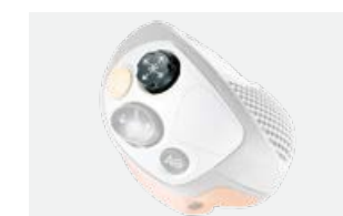
Přestavení stolu žacího ústrojí VARIO, kosy MAXFLEX a rychlosti VARIO, přepravního pásu MAXFLO na multifunkční ovládací páce CMOTION
