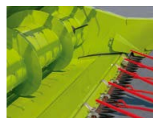
Vysunutí stolu žacího ústrojí – obilí (+ 100 mm)
