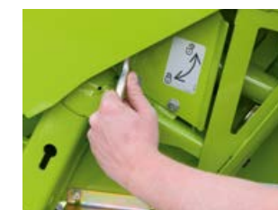
Zajištění děliče bez použití nářadí přes rychloupínání
