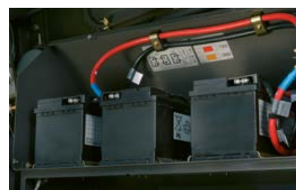
Tři baterie pro mlátičku TUCANO: dvě jsou zapojeny v řadě pro 24-V elektroniku motoru, jedna zásobuje 12-V palubní elektroniku.
