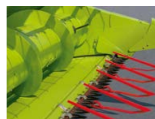
Zasunutí stolu žacího ústrojí – obilí (– 100 mm)
