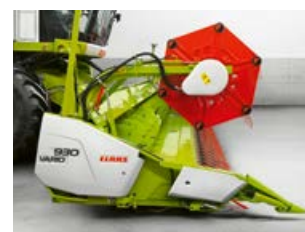
Vysunutí stolu žacího ústrojí – obilí (+ 600 mm)
