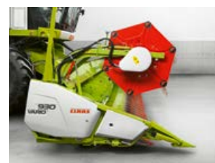
Zasunutí stolu žacího ústrojí – obilí (– 100 mm)
