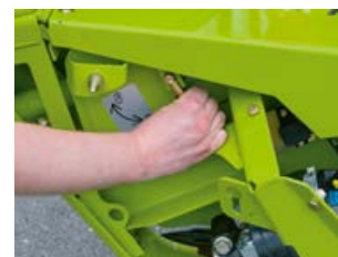
Zajištění děličů a dělicí kosa pro sklizeň řepky bez použití nářadí pomocí rychloupínání
