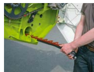
Náhradní kosa je vložena do spodní části žacího ústrojí
