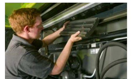
Výměna předního koše MULTICROP
