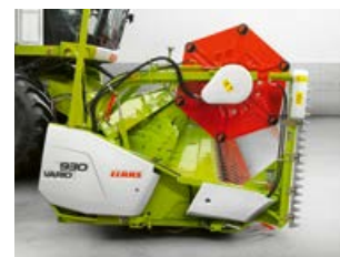
Zasunutí stolu žacího ústrojí – s řepkovými děliči (+ 450 mm)
