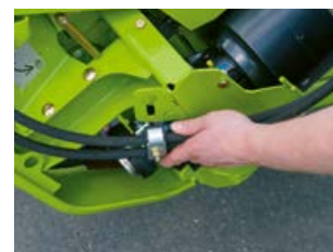
Snadné připevnění hydraulických hadic pro pohon řepkových děličů
