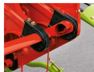
Nosiče prstů přiřaněče a ložiska z plastu s optimálním tvarem pro menší unášení stébel
