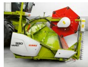
Vysunutí stolu žacího ústrojí – s řepkovými děliči (+ 600 mm)
