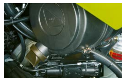
Odsávací ventil spolehlivě odstraňuje nečistoty ze vzduchového filtru.
