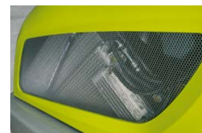
Velké plochy pro nasávání vzduchu na bloku chladičů
