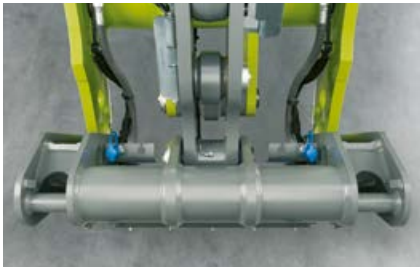
Vše je připraveno pro skryté uložení dvou hydraulických rychlospojek pro další hydraulický okruh
