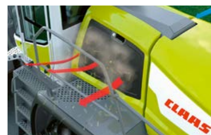
Sací plochy a chladič jsou zbaveny prachu a nečistot
