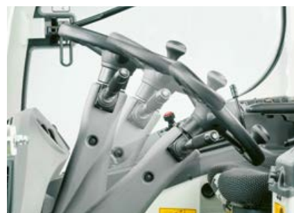
Sloupek řízení s plynulým nastavením sklonu.
