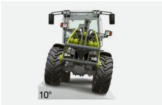
Robustní výkyvný kloub s úhlem odklonu 10° vyrovnává nerovnosti a zajišťuje tak vysokou stabilitu a vysoký jízdní komfort.
