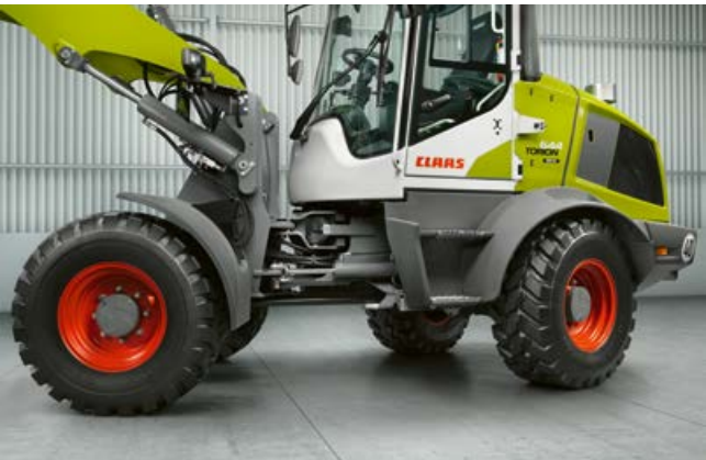
Přestože se TORION vychyluje méně na středovém kloubu, je díky řízené zadní nápravě obratnější a zvedne víc.
