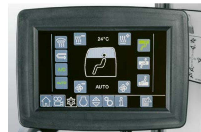
Ovládání klimatizace probíhá volitelně přes klávesnici nebo přes dotykový displej
