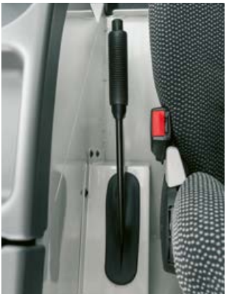
Mechanická parkovací brzda vlevo u sedadla řidiče
