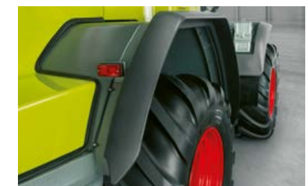
TORION 1511-1177: rozšíření blatníků vzadu pro pneumatiky s šířkou 620 mm
