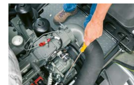
Nášlapná plocha ve vnitřní části kapoty motoru pro větší komfort údržby
