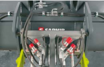
Veškerá hydraulická připojení jsou dobře dostupná a zároveň dobře chráněna na nosiči nářadí.
