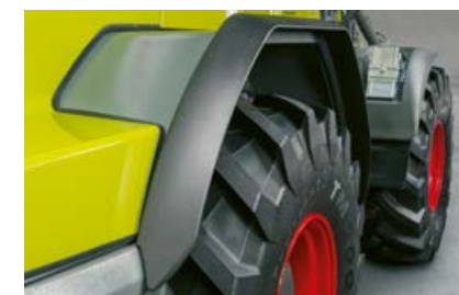
TORION 1511-1177: rozšíření blatníků vzadu pro pneumatiky s šířkou 620 mm
