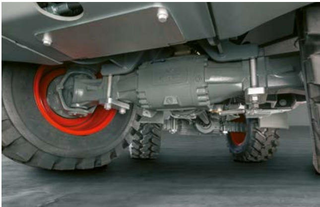
Jakmile řidič uvede kolový nakladač volantem do rejdu, zadní náprava se synchronizuje.
