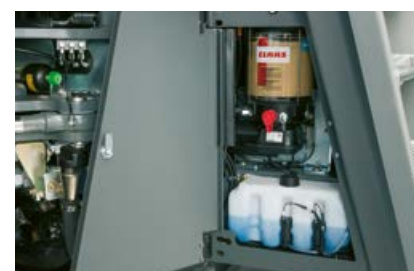
Zásobník maziva pro centrální mazací zařízení a systém ošťikovačů jsou dobře viditelné v oblasti vstupu.
