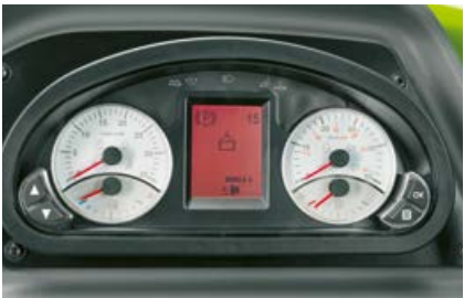
Přístrojová deska základní třídy s černobílým displejem.
