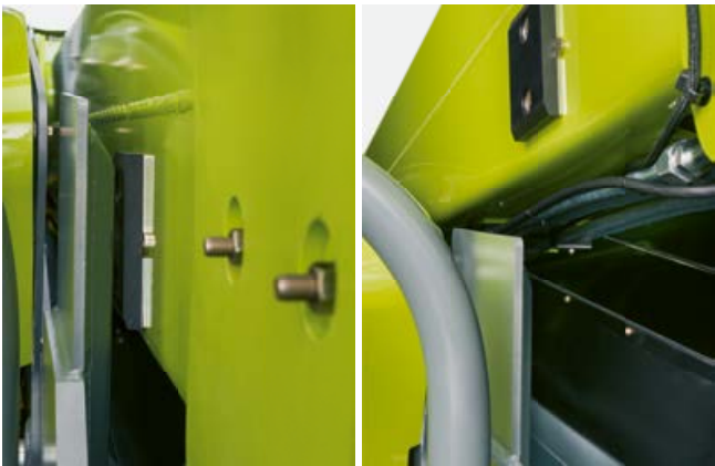
Boční vedení výložníku sériově u modelů SCORPION 756 / 746.
