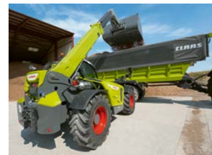
Systém vážení umožňuje přesné plnění odvozových prostředků.
