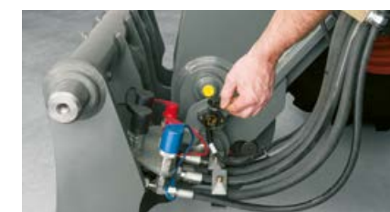
Zásuvky pro flexibilní přívod elektřiny pro nejrůznější pracovní nářadí a připojená nářadí
