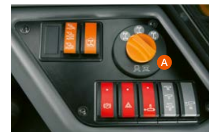
Otočný, tlačítkový spínač (A) k výběru způsobu řízení v modelech SCORPION VARIPOWER.
