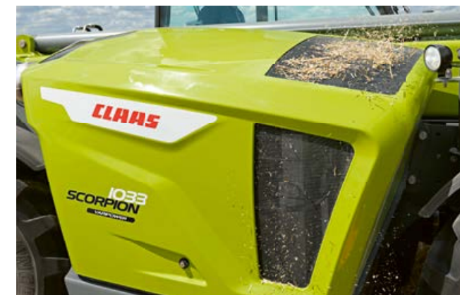
Minimální znečištění chladiče díky reverznímu ventilátoru.
