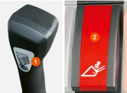
Rychlá a bezpečná výměna pracovního nářadí pomocí kolébkového tlačítka (1) a kolébkového spínače (2).
