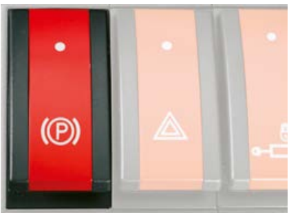
Parkovací brzda může být kolébkovým spínačem aktivována manuálně.
