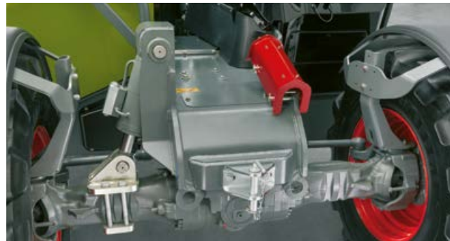
Větší bezpečnost v terénu díky funkci hydraulického vyrovnávání
