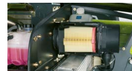
Vzduchový filtr motoru je velmi dobře přístupný a jeho údržbu lze provádět bez použití nářadí.
