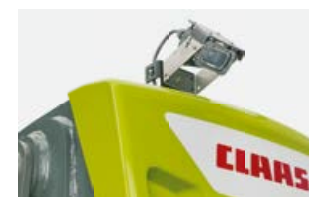
PROFI CAM vzadu vidí všechno, co se odehrává za zády řidiče.
