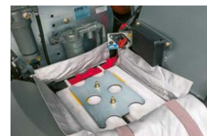
Baterie a odpojovač modelu TORION 1511-1177 jsou bez problému přístupné.
