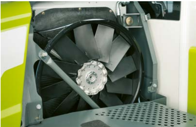
Otáčky ventilátoru se u nakladače TORION (obr. TORION 1914 / 1812) plynule přizpůsobují podmínkám.
