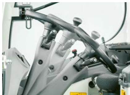
Sloupek řízení s plynulým nastavením sklonu.
