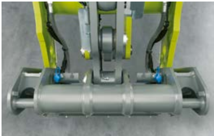
Vše je připraveno pro chráněnou montáž dvou hydraulických rychlospojek pro další hydraulický okruh
