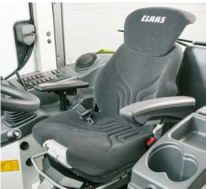
Pneumatikky odpružené, vyhřívané sedadlo s vysokou opěrkou zad
