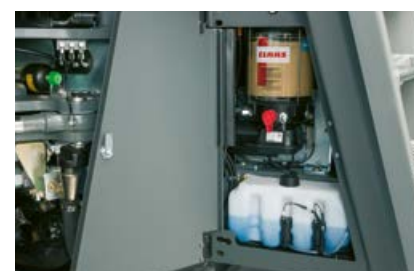
Zásobník maziva pro centrální mazací zařízení a systém ostřikovačů jsou dobře viditelné v oblasti vstupu.
