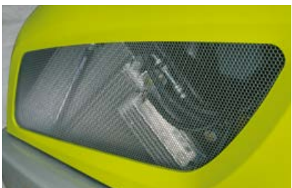
Velkoobjemové plochy pro nasávání vzduchu na bloku chladičů
