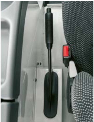
Mechanická parkovací brzda vlevo u sedadla řidiče
