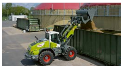
Nejjednodušší obsluha všech pracovních nářadí s přídavným hydraulickým okruhem přes multifunkční ovládací páku
