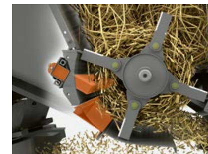
Protiostrí a výkyvný prvek dna řezačky slámy v SPECIAL CUT.
