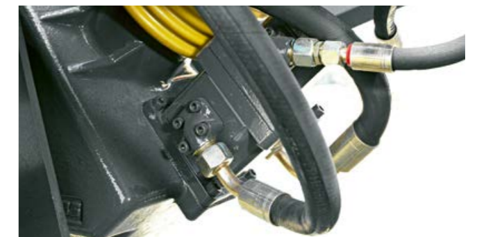
Dvě olejová čerpadla zásobují vstupní převodovku a systém čištění uzlovačů TURBO FAN hydraulickým olejem.
