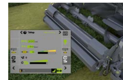
Hydraulický systém vkládání lze nastavit pohodlně ze sedadla řidiče traktoru.
