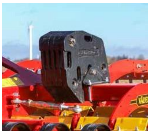
Carrier 300-400 je možno vybavit sadami závaží a výsledkem je hmotnost až 800 kg/m.
