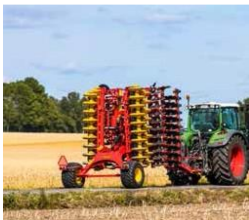
Při přepravě stroje Carrier XL 425-625 mezi poli se jeho křídla složí na přepravní šířku 3 m.
