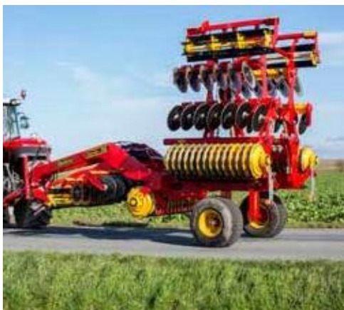
Pro ulehčení transportu se Carrier 420-820 složí na přepravní šířku 2,5 metru.
