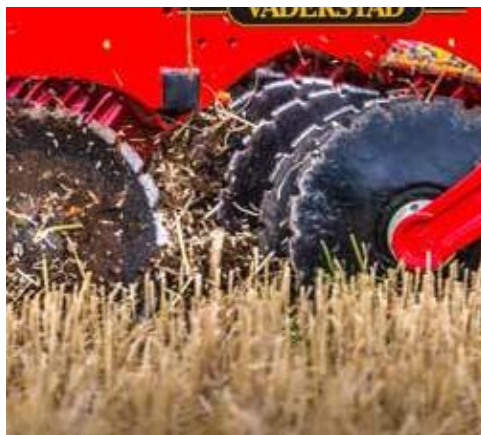
Dvě řady kotoučů z kvalitní švédské oceli V-55 pracují do hloubky 12 cm.
