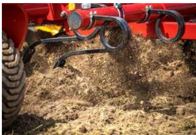
Vibrující radličky Swift zajišťují intenzivní míchání do pracovní hloubky 20 cm.
