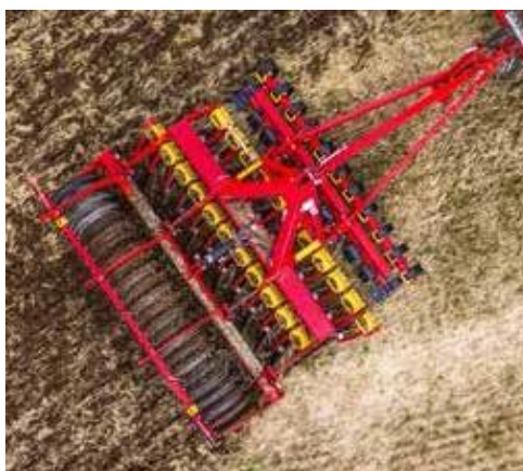
Carrier 300-400 může být dodán buď jako tažený, nebo jako nesený stroj.
