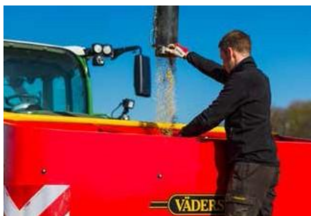
Zkosená konstrukce přední části poskytuje řidiči dobrý výhled. Velký otvor a vestavěný schůdek usnadňují plnění.
