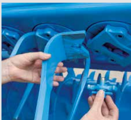
Výměna rychloupínacích nožů
